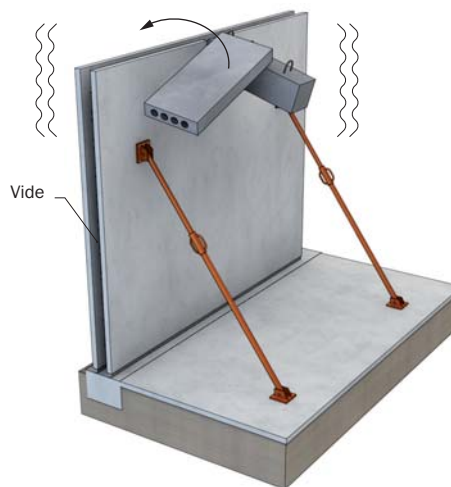
PRÉMUR VIDE POUTRE NON CLAVETÉE
