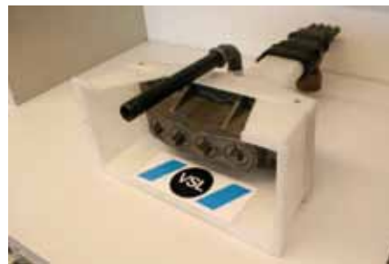
Exemple d'ancrages 4 torons avec système d'injection
