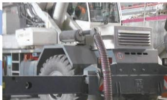
Pot d'échappement de la grue mobile relié au système d'aspiration centralisé.
