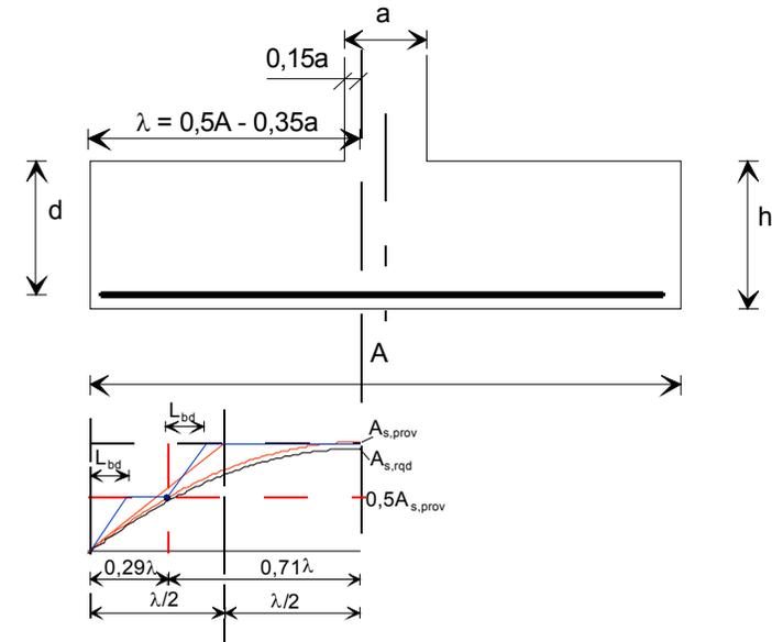
Pour un béton coulé sur béton de propreté avec un enrobage au nu de 30 mm
